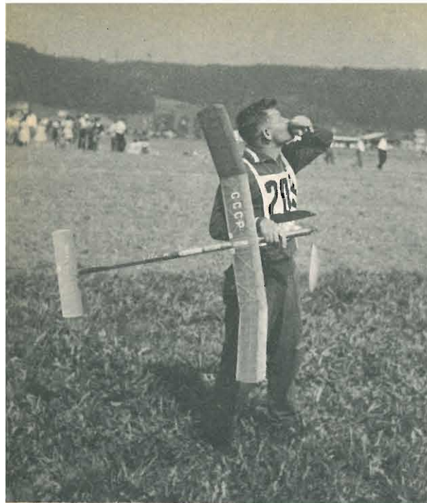
Un modello Wakefield russo, la cui fusoliera è costituita, per la parte anteriore, da un tubo di alluminio.
