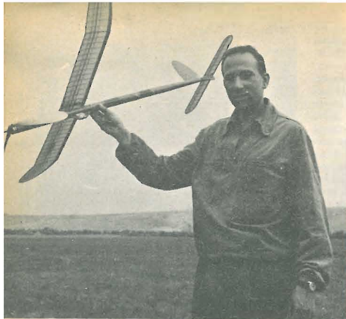
Un bellissimo Wakefield la cui fusoliera è realizzata con il sistema illustrato in fig. 11. Si noti sotto la pinnetta con l'autoscatto per l'installazione dell'antitermica.
